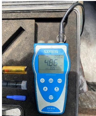
ค่า DO Meter เท่ากับ 4.86 mg/L
