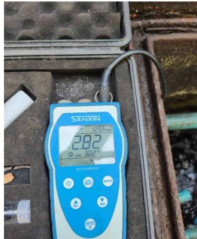
ค่า DO Meter เท่ากับ 2.82 mg/L
