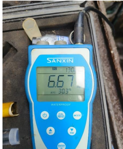
ค่า DO Meter เท่ากับ 6.67 mg/L
