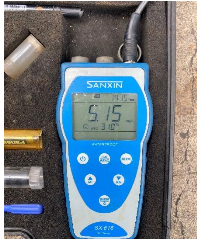
ค่า DO Meter เท่ากับ 5.15 mg/L
